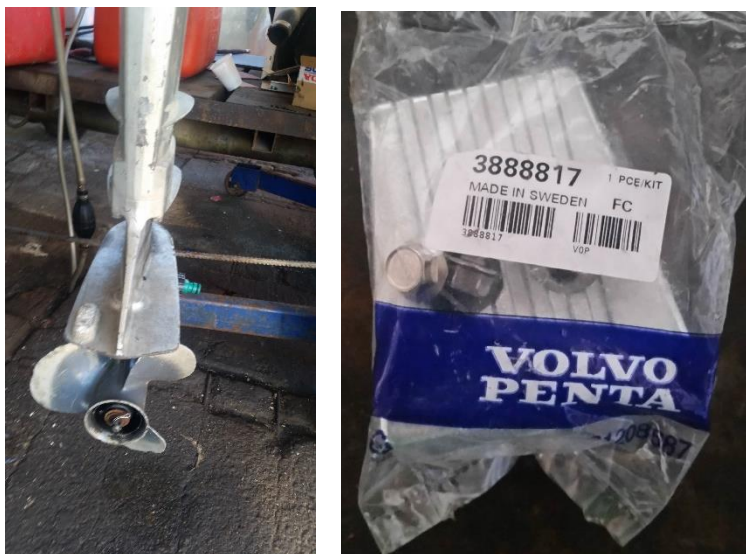
Slika 3.1. Propeler i cink-anoda
