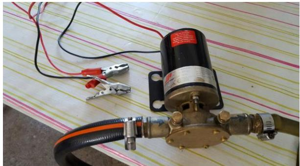
**Slika 3.3.** Pumpa (mehanička i električna) za izvlačenje ulja iz motora
