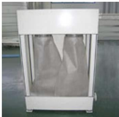
Slika 3.12. Filterske vreće za mehaničku dehidraciju mulja i pijeska
