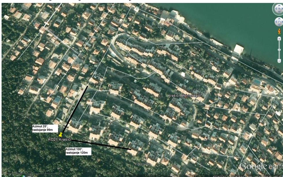
**Slika 11.** Raspored objekata u odnosu na azimute pravaca maksimalnog zračenja antena
