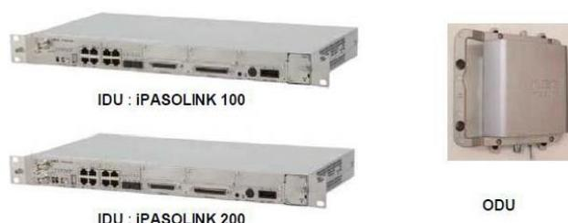
Slika 8. Izgled IDU i ODU jedinice
