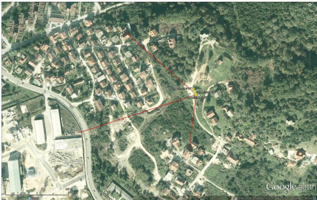
**Slika 10.** Raspored objekata u odnosu na azimute pravaca maksimalnog zračenja antena
