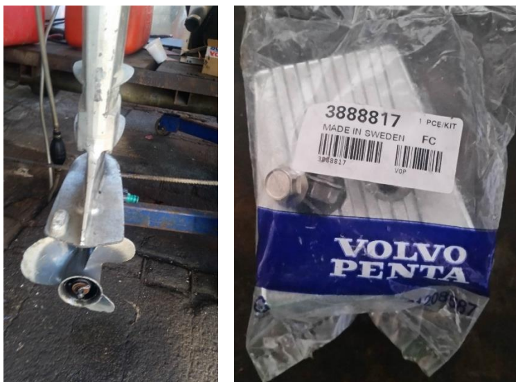
Slika 3.2. Propeler i cink-anoda
